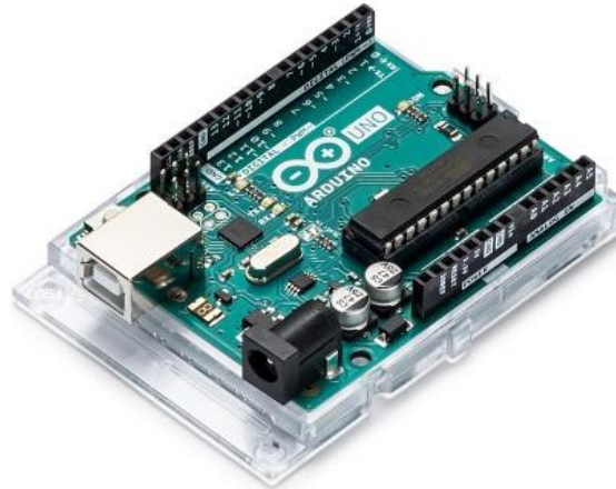
Figura 07: Arduino UNO, (“um” em italiano. Reprodução: arduino.cc).
