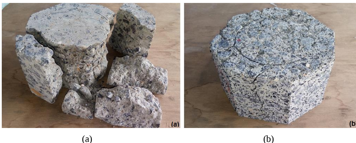
Figura 8 - Corpos-de-prova após duas horas de rompimento: (a) Convencional; (b) Com resíduos.
