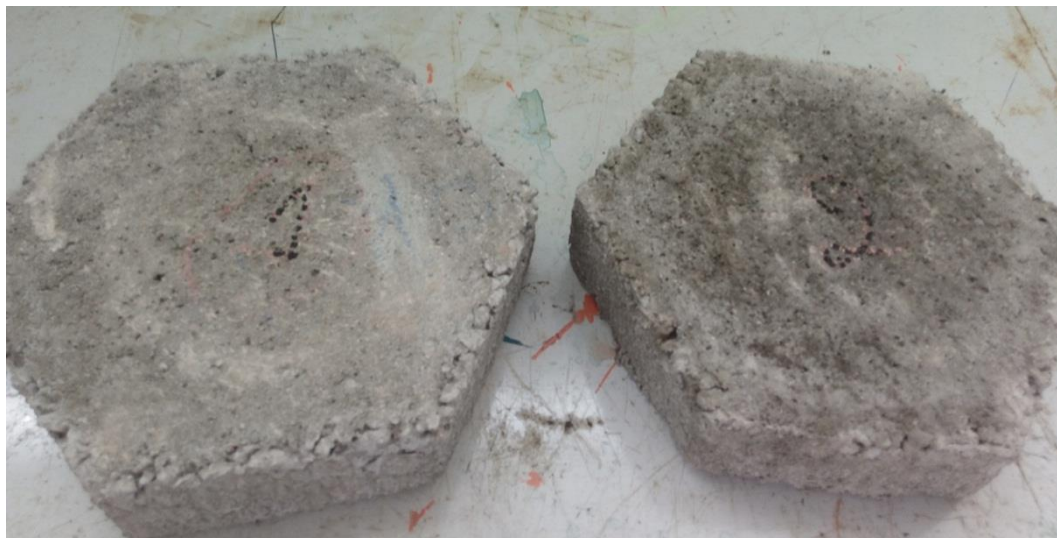
Figura 4 – Blocos sextavados, respectivamente Traços 1 e 2
