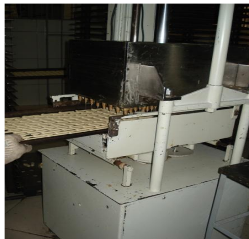
Figura 3 – Injeção de massa nos tabuleiros
