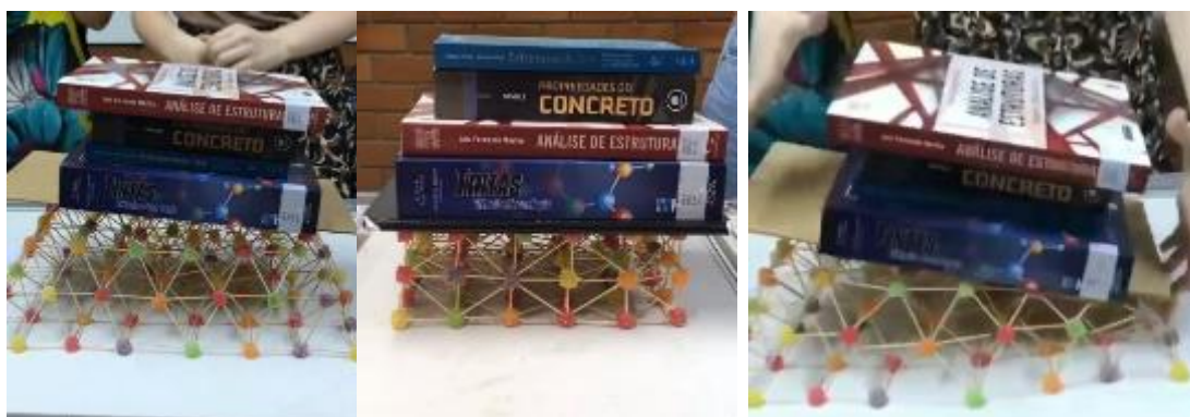
Ilustração 6 – Testes de carga nas estruturas com jujubas (a) e (b). Estrutura rompida (c). Detalhe para o uso de uma base rígida para distribuir a carga por toda a superfície da maquete
