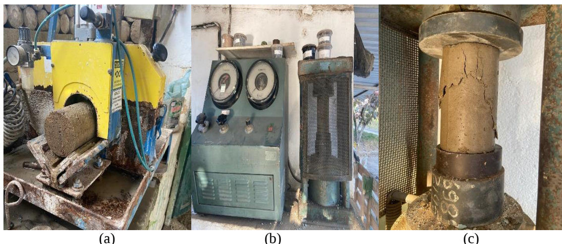
Figura 4 – (a) Retificação do corpo de prova; (b) Carga aplicada ao corpo de prova na prensa; (c) Ruptura do corpo de prova. Fonte. O autor, 2024.
