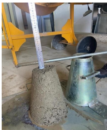
Figura 6 - Teste de abatimento de tronco de cone. Fonte: O autor, 2024.
