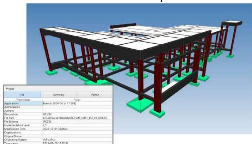
Figura 3 – Modelo estrutural em IFC da UBS disponibilizado no âmbito do PAC
