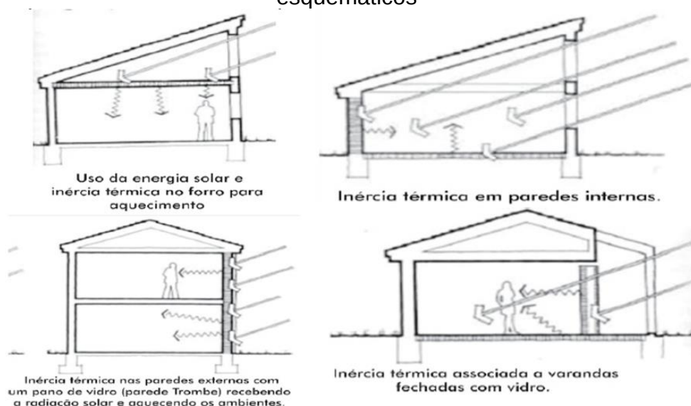
Figura 19- Estratégias de Massa térmica com Aquecimento Solar- cortes esquemáticos
