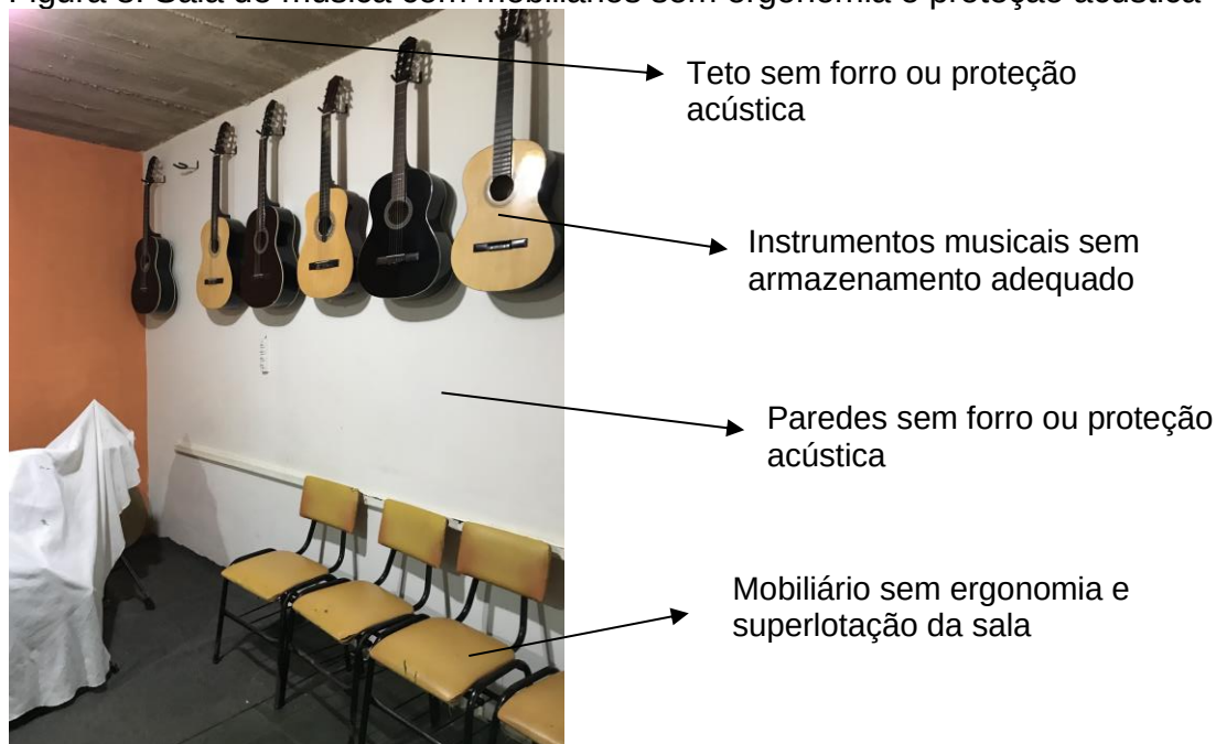
Figura 8: Sala de música com mobiliários sem ergonomia e proteção acústica
