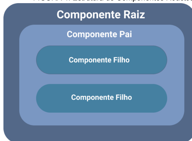
FIGURA 4: Estrutura de Componentes ReactJs
