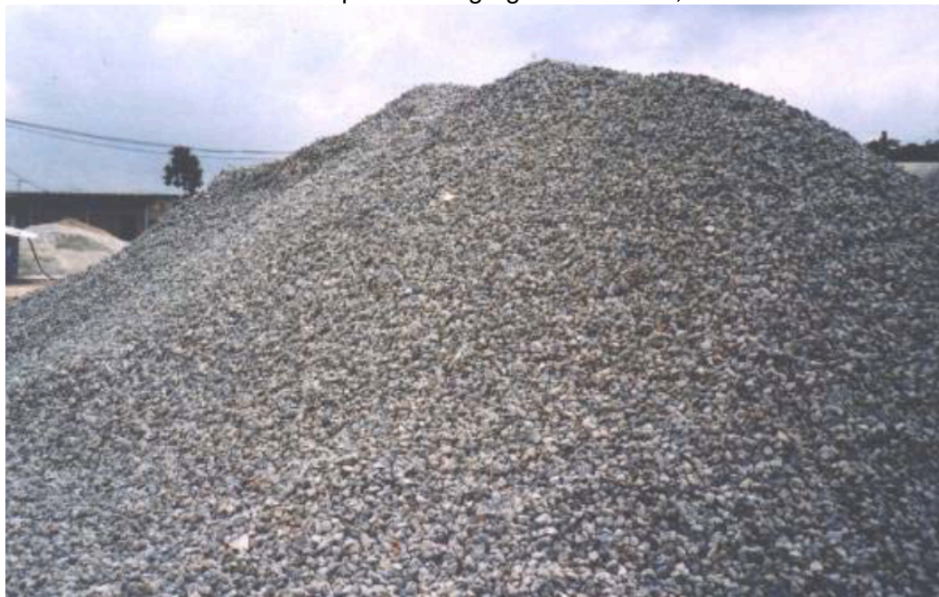
FIGURA 4. Depósito de agregado reciclado, Brita 1
