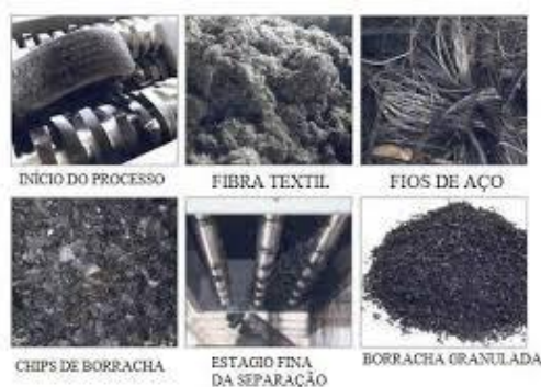
Figura 03: Processo de trituração e moagem de pneu.
