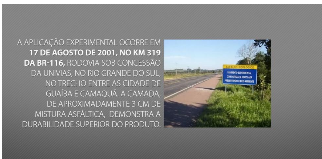
Figura 01: Primeira aplicação experimental do asfalto borracha no Brasil.
