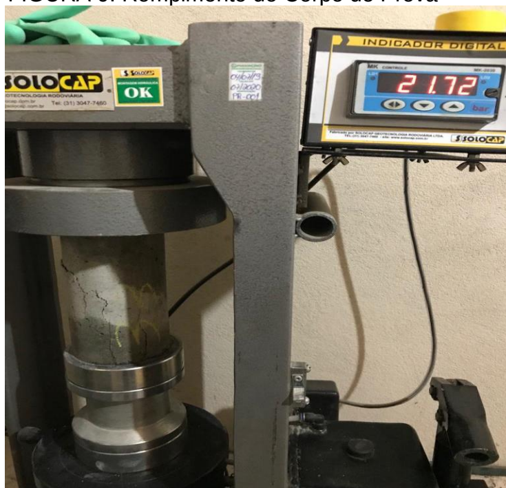
FIGURA 9: Rompimento do Corpo de Prova
