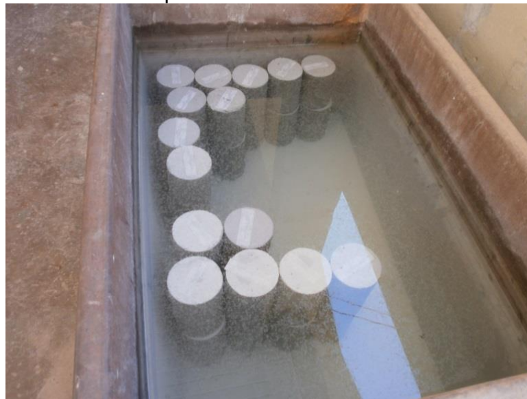
FIGURA 8: Tanque de Cura Remota
