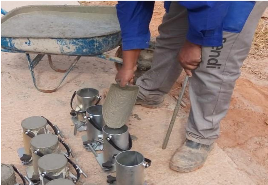
FIGURA 2: Colocando Concreto no Molde
