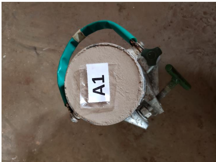
Figura 7 – Moldeira com corpo de prova da amostra A1
