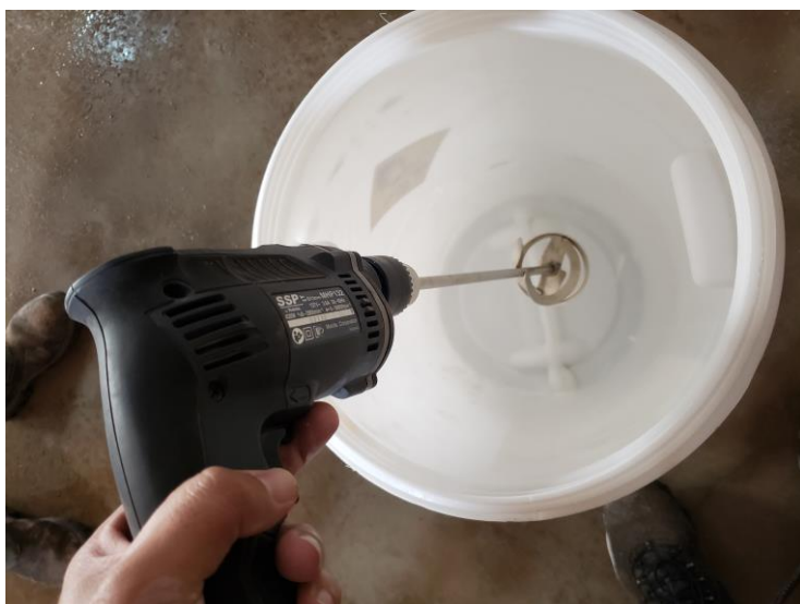
Figura 4 – Recipiente de mistura e furadeira equipada com misturador
