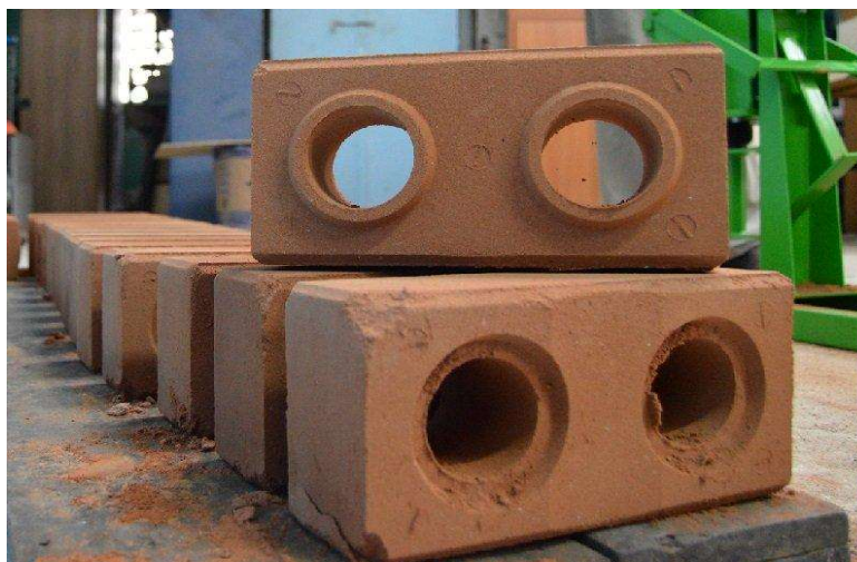
FIGURA 1 - Tijolo solo cimento
