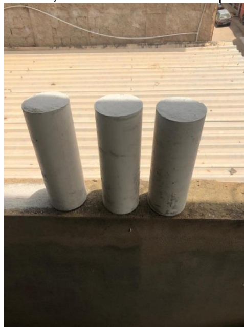
Figura 15: Elaboração dos blocos de ensaio 1, 2 e 3 de concreto simples
