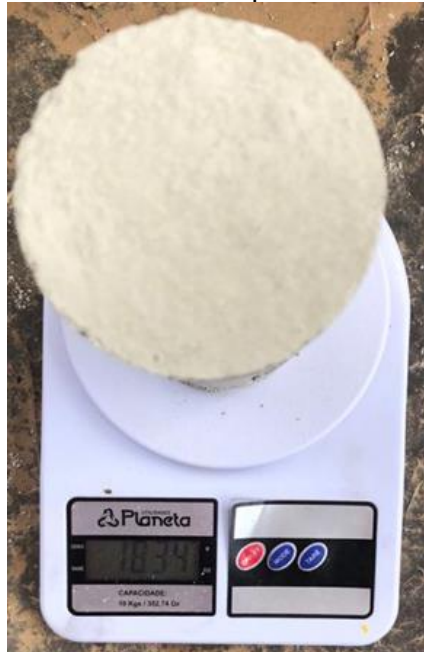
Figura 19: Peso inicial e final do bloco 3 que não foi submetido à ação do fogo
