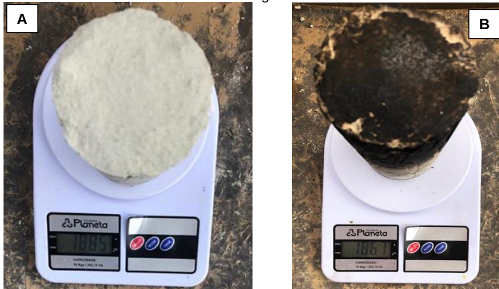
Figura 17: (A) Peso inicial do bloco 1; (B) Peso do bloco 1 após exposição ao fogo e resfriamento com água
