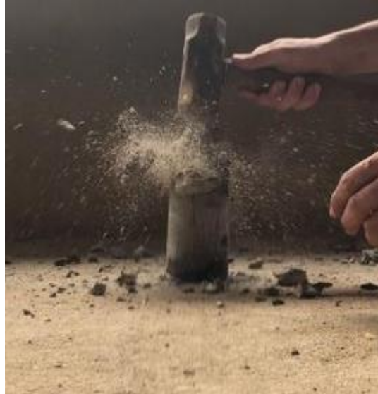
Figura 21: Golpe realizado no bloco 2 demonstrando a redução de seu tamanho e resistência
