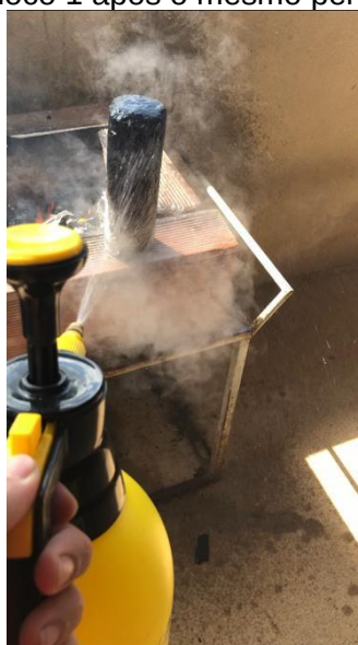
Figura 16: Resfriamento do bloco 1 após o mesmo permanecer sob o fogo uma hora
