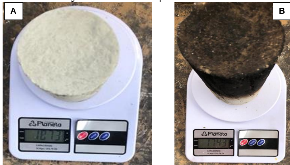
Figura 18: (A) Peso inicial do bloco 2 antes da ação do fogo; (B) Peso do bloco 2 após exposição ao fogo e resfriamento à temperatura ambiente
