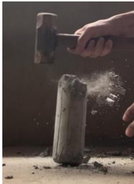
Figura 22: Bloco 3 (caso controle) com poucas alterações observadas devido a manutenção de sua resistência máxima
