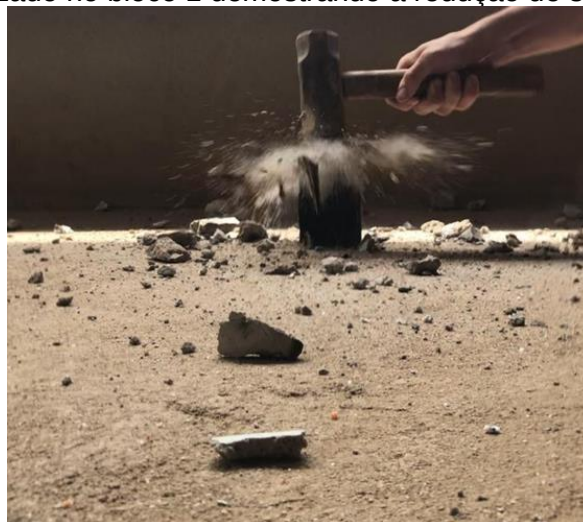
Figura 20: Golpe realizado no bloco 1 demonstrando a redução de seu tamanho e resistência
