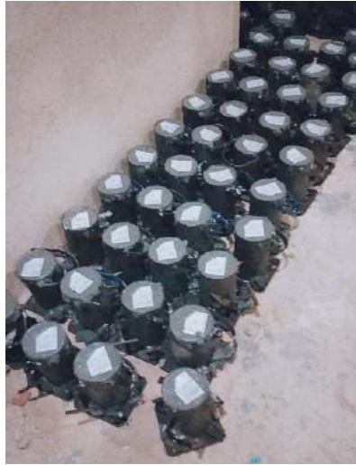
Figura 7. Amostras dos traços de concreto com e sem adição de escória.
