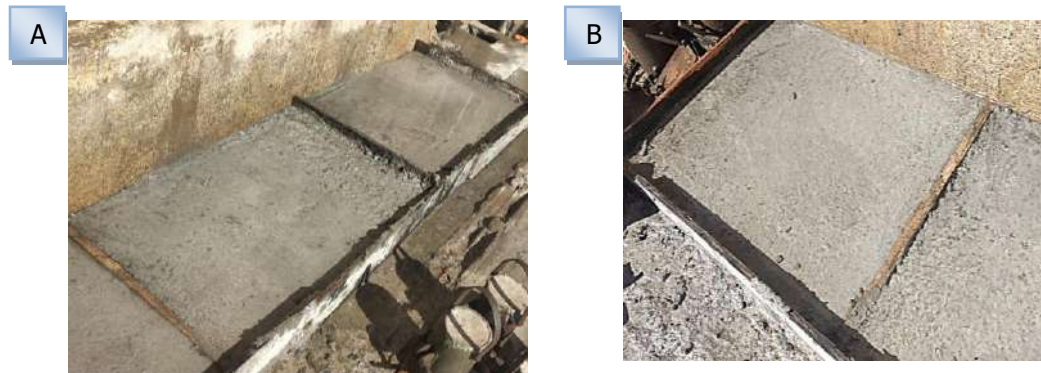
Figura 9. Concreto dos traços espalhados em formas para verificação da retração.
