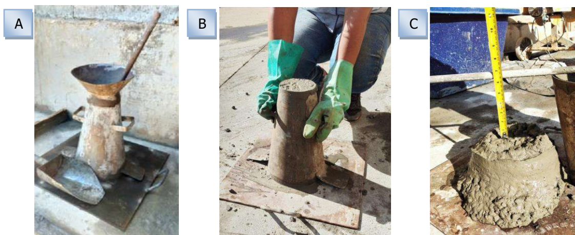
Figura 5. Processo de execução do Ensaio de Abatimento do tronco de cone.
