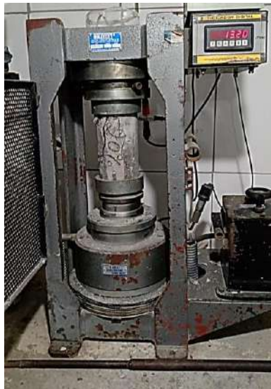
Figura 11. Rompimento dos Corpos de prova
