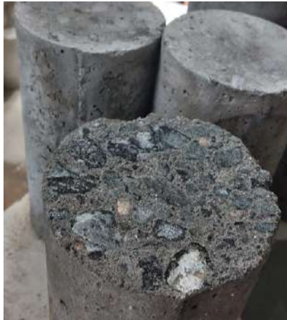
Figura 10. Aparência da amostra com 30% de substituição e 7 dias de cura.
