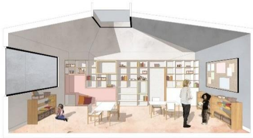
Figura 13 – Corte Transversal que representa a proposta de mobiliário Montessori, a abertura zenital, para uma melhor ventilação e iluminação
