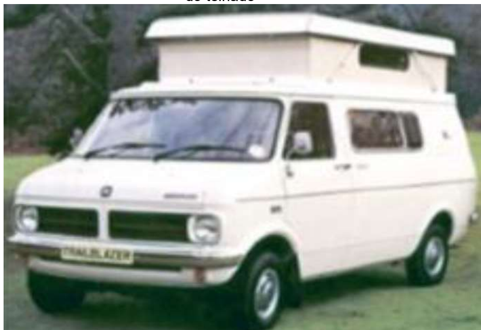
FIGURA 3 - Trailblazer , 1976 em uma Bedford CF220 com novo projeto de elevação do telhado
