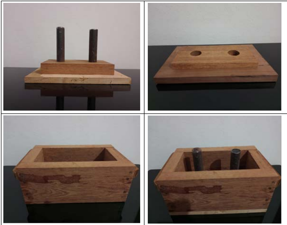
FIGURA 06 – Detalhes da fôrma projetada: Base da forma com moldes para os orifícios (canto superior esquerdo); Tampa da fôrma com encaixes para os moldes dos orifícios (canto superior direito); Caixote externo da fôrma (canto inferior esquerdo); Fôrma montada sem a tampa (canto inferior direito).
