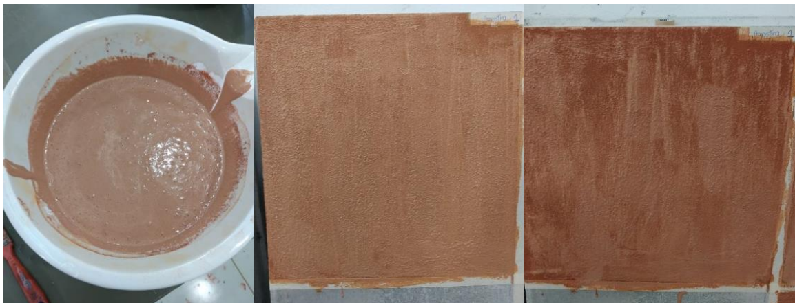
Figura 5 – Mistura, e aplicação da tinta da amostra 1 em uma e duas camadas.
