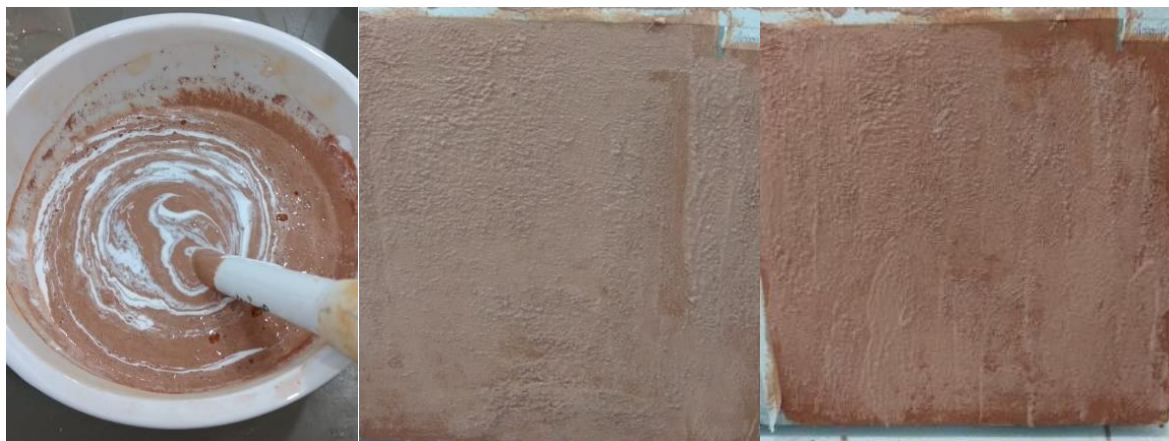
Figura 9 – Mistura, e aplicação da tinta da amostra 3 em uma e duas camadas.
