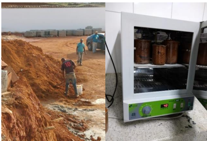
Figura 2 – Loteamento onde foi feita a retirada do material, e material sendo colocado em estufa por 24h
