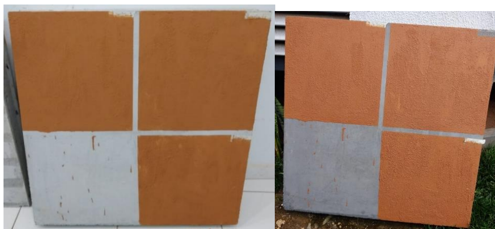
Figura 11 – Blocom, com a tinta seca, 13 dias após aplicação, e depois, exposta ao sol e chuva durante 11 dias.
