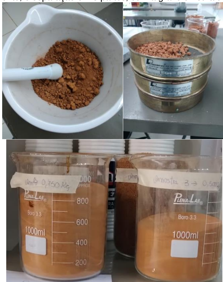
Figura 3 – Material após 24h em estufa a 200°C, sendo realizado o destorroamento e peneiramento, e separação em 3 partes, com a granulometria de 0,60mm.
