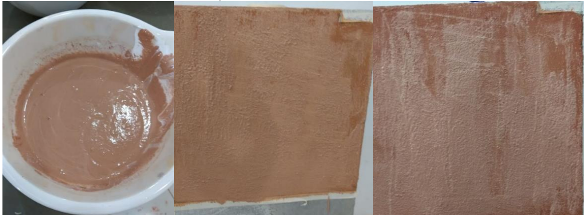
Figura 7 – Mistura, e aplicação da tinta da amostra 2 em uma e duas camadas.
