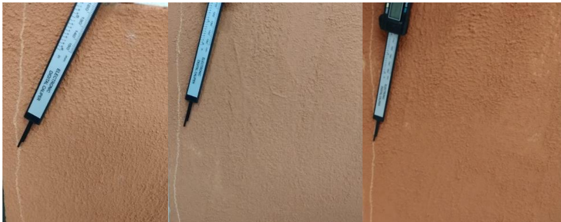
Figura 13 – Deformação após corte, das amostras 1, 2, e 3, respectivamente
