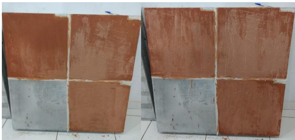
Figura 10 – Blocom, com primeira e segunda camada de tinta, no dia da aplicação
