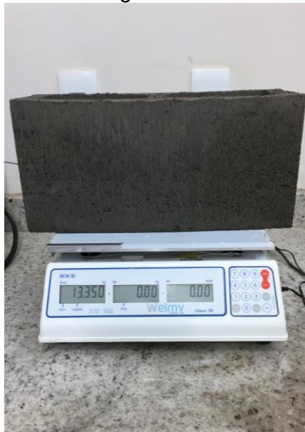
FIGURA 6 – Pesagem da amostra saturada
