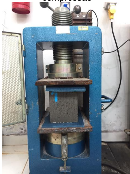
FIGURA 8 – Amostra colocada na prensa para realizar o ensaio de resistência à compressão
