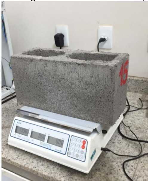
FIGURA 3 – Pesagem da amostra em condições naturais
