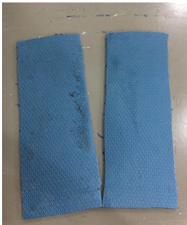
FIGURA 7 – Manta emborrachada utilizada para realizar o capeamento
