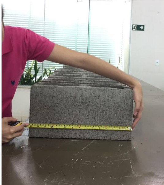
FIGURA 1 – Medição do comprimento
