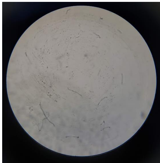
FIGURA 8 - Resina Llis A2 antes das etapas de polimento na lente do microscópio WF 10X/18-Laboratório de Microscopia (100 vezes de aumento)
