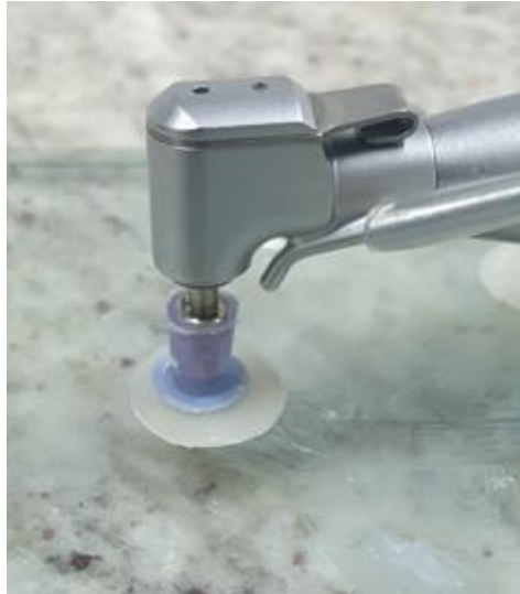
FIGURA 12 - Polimento dos corpos de prova com a pasta de polimento da DiamondR
