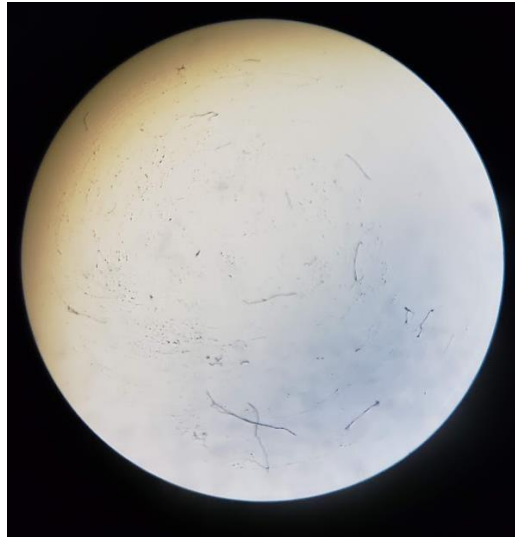
FIGURA 15 - Resina Llis A2 após as etapas de polimento na lente do microscópio WF10X/18-Laboratório de Microscopia (100 vezes de aumento).
