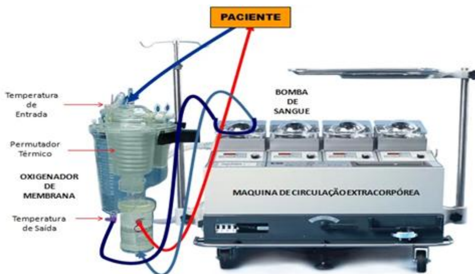
FIGURA 1. Esquematização do equipamento de Circulação Extracorpórea
