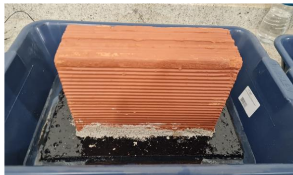
(f) 28 horas de ensaio concreto com emulsão asfáltica
