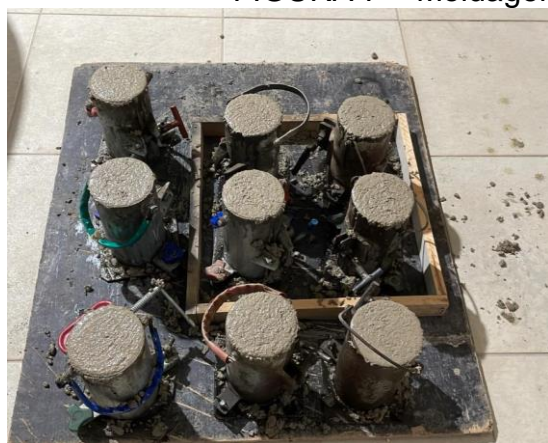
(a) Corpos de prova recém moldados Fonte: O Autor, 2024.
