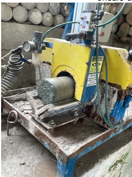
(a) Capeamento dos corpos de prova
