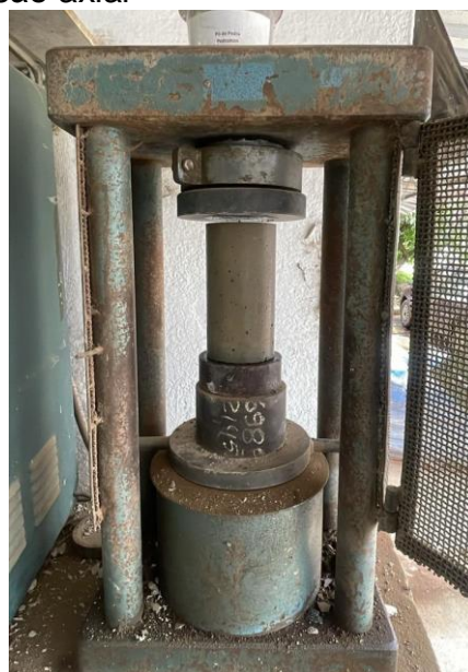
(b) Posicionamento dos corpos de prova na prensa de ensaio
