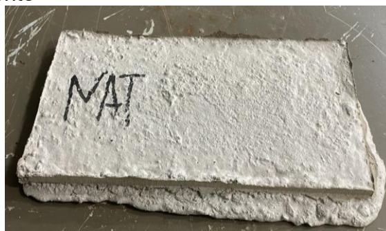
(b) Placa em concreto natural
