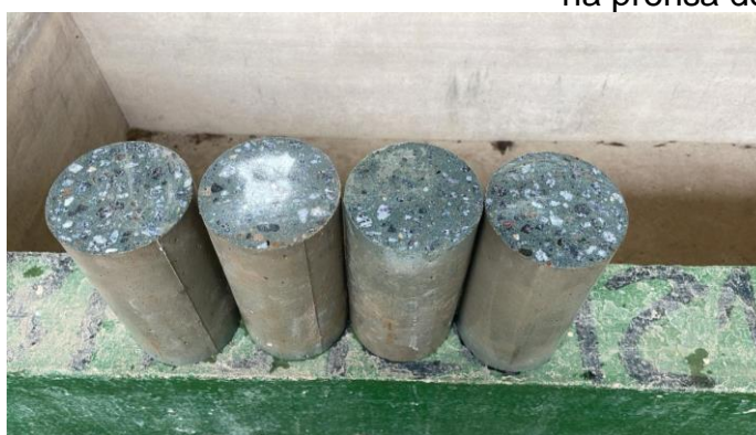
(c) Corpos de prova capeados
