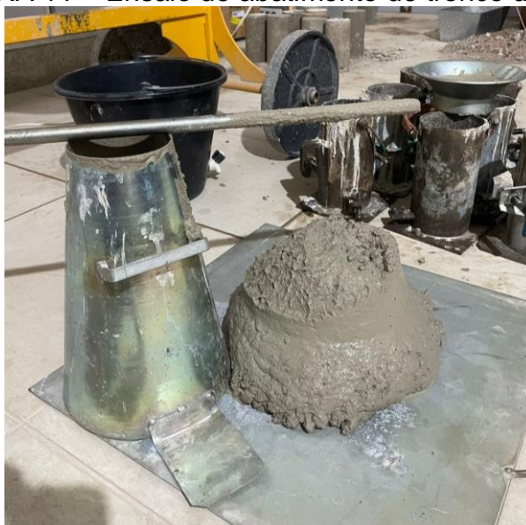
FIGURA 11 – Ensaio de abatimento de tronco de cone
