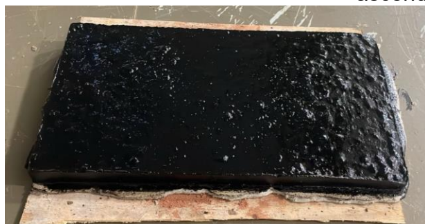
(a) Placa de concreto impermeabilizada com emulsão asfáltica
