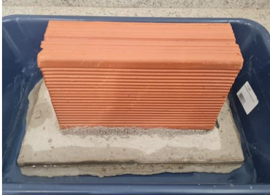
(a) 1 hora de ensaio concreto natural
