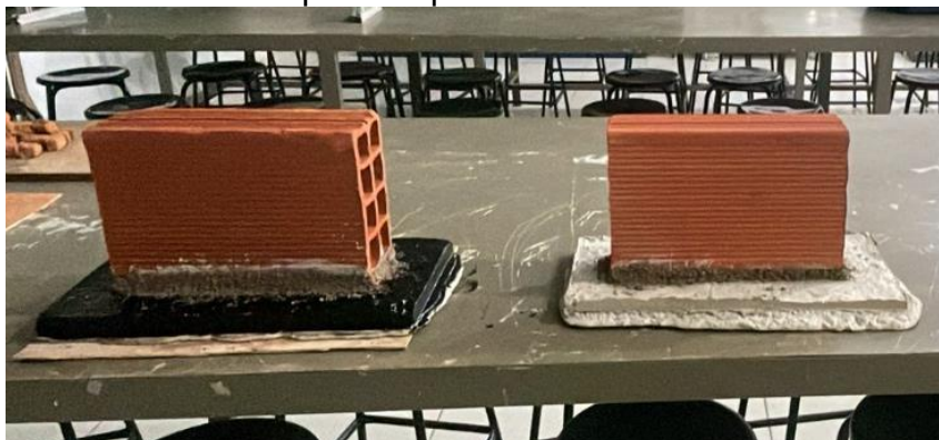
FIGURA 10 – Amostras prontas para o ensaio de umidade ascendente
