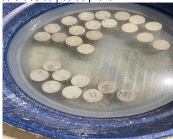
(b) Tanque de cura dos corpos de prova
