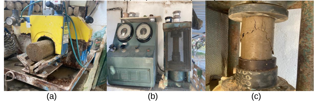
FIGURA 7 – (a) Retificação do corpo de prova; (b) Carga aplicada ao corpo de prova na prensa; (c) Ruptura do corpo de prova.
