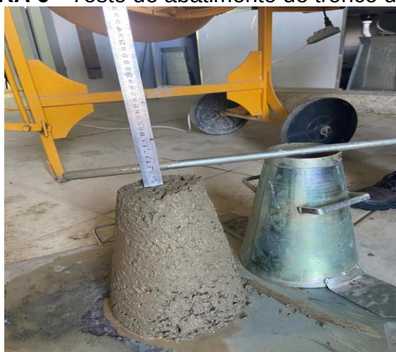
FIGURA 6 - Teste de abatimento de tronco de cone
