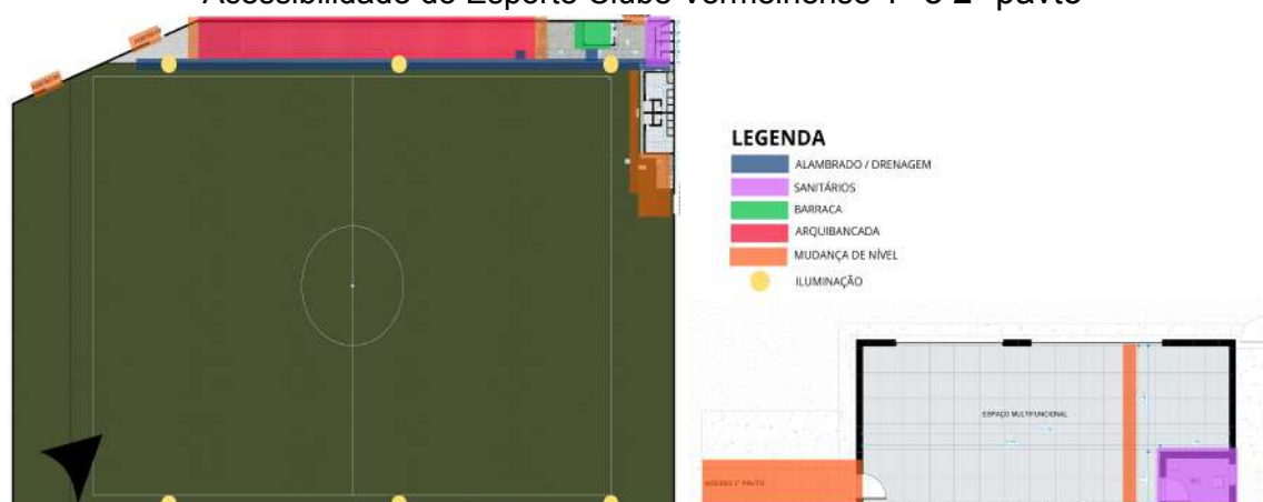
Figura 30 – Mapa de Setorização de Danos Estruturais e Inconformidades de Acessibilidade do Esporte Clube Vermelhense 1º e 2º pavto
