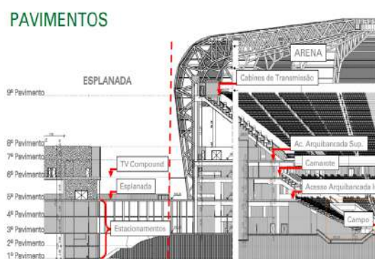
Figura 02 – Corte esquemático da estrutura da Arena MRV
