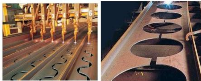
FIGURA 12 – Corte e soldagem de vigas celulares
