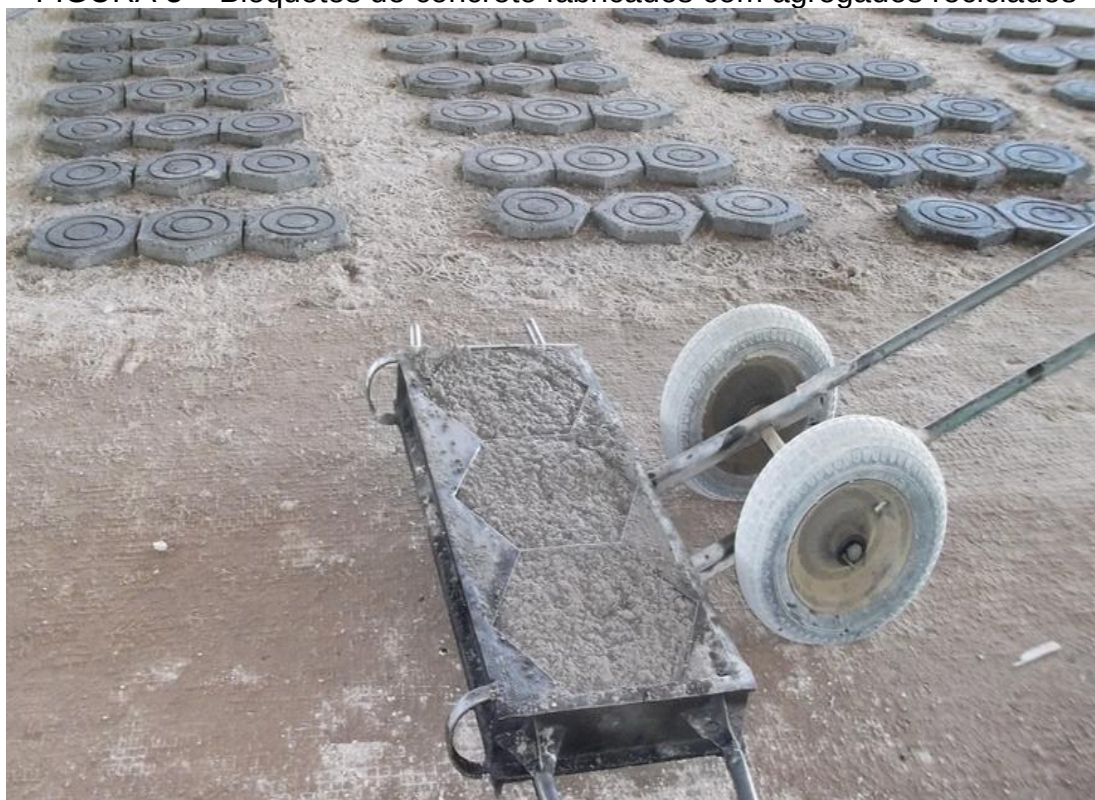
FIGURA 5 – Bloquetes de concreto fabricados com agregados reciclados
