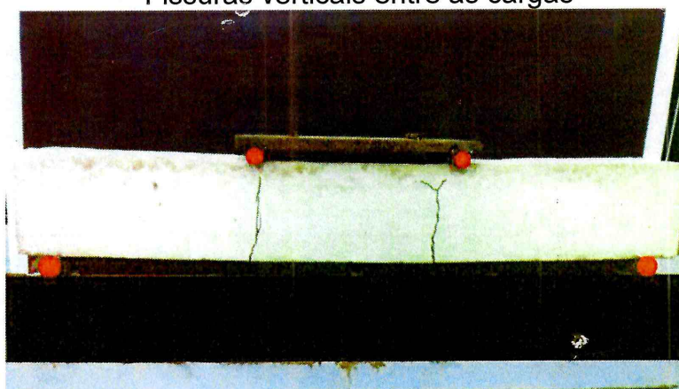
Figura 16 – Configuração de ruptura do Corpo de prova C-RCC 50 B após o ensaio – Fissuras verticais entre as cargas
