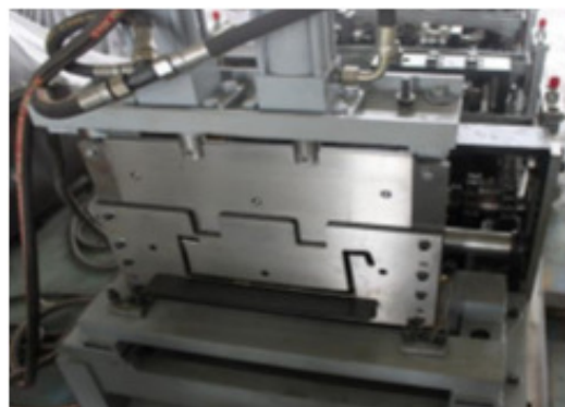
FIGURA 5 – Processos de fabricação dos PFFs: (a) prensa dobradeira e respectivas representações esquemáticas dos processos de fabricação (b) processo de dobramento
