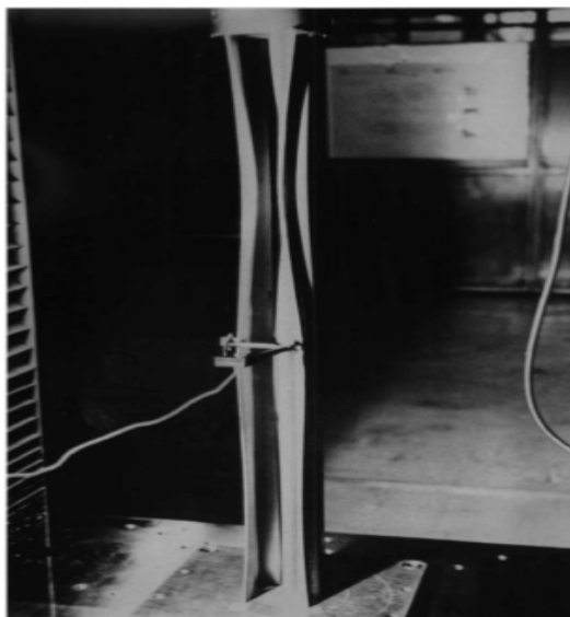
FIGURA 12 – Ensaio de coluna bi-engastada sobre o efeito da flambagem distorcional
