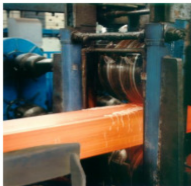
FIGURA 6- Produção de perfil metálico com seção transversal de quatro lados.
