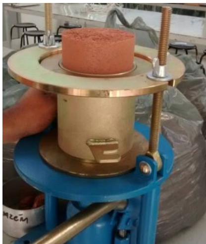
Figura 11 – Extração do corpo de prova no ensaio Proctor Normal
