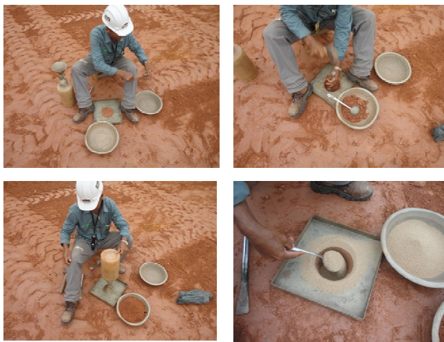
Figura 15 – Ensaio por meio do Método do Frasco de areia “In Situ”
