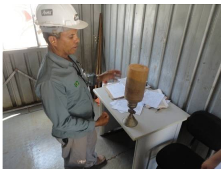
Figura 13 – Método Frasco de areia utilizado “In Situ”
