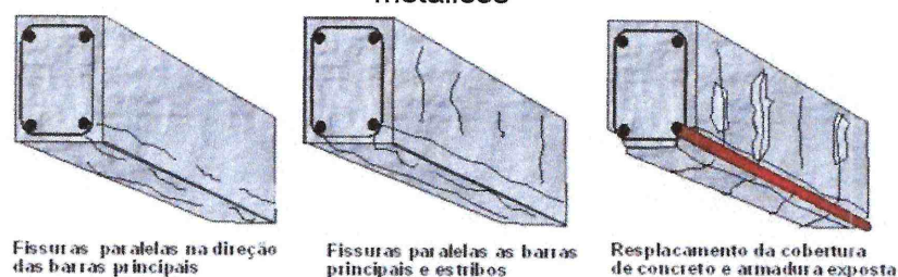
FIGURA 10.0- Fissuração e lascamento do concreto paralelamente as barras e estribos metálicos
