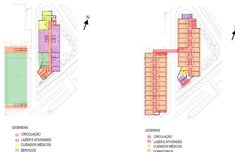
Figuras 3 e 4 – Planta baixa pavimento térreo e pavimento superior respectivamente do lar dos idosos em Perafita
