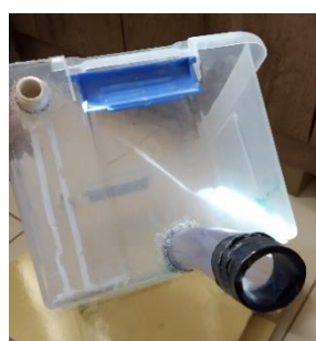
Figura 4 - C – Saída de 25 mm do reservatório 1 (Fonte: Os autores).
