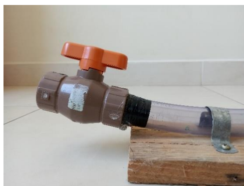
Figura 7 - C – Extremidade do tubo com registro (Fonte: Os autores).
