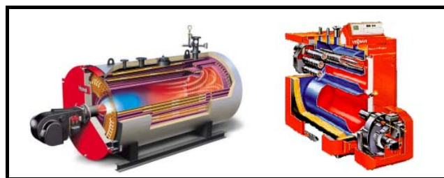
Figura 1: Esquema de uma caldeira aquatubular (à esquerda) e caldeira gastubular (à direita)
