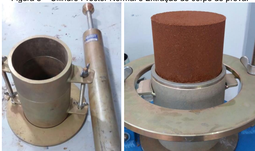
Figura 3 – Cilindro Proctor Normal e Extração do corpo de prova.
