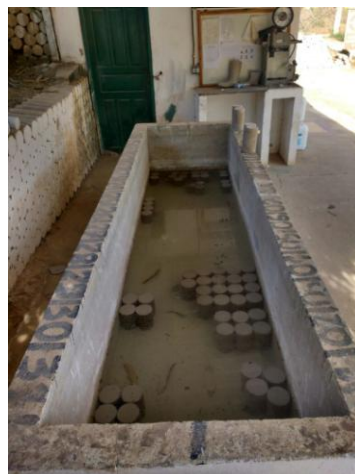
Figura 1 – Tanque de cura dos corpos de prova
