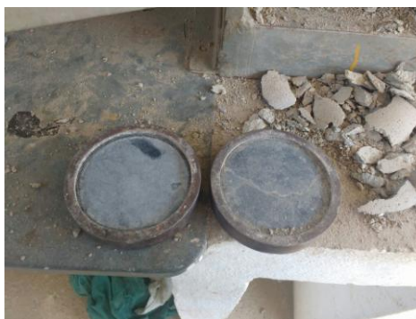
Figura 2 – Neoprene usado no capeamento dos corpos de prova
