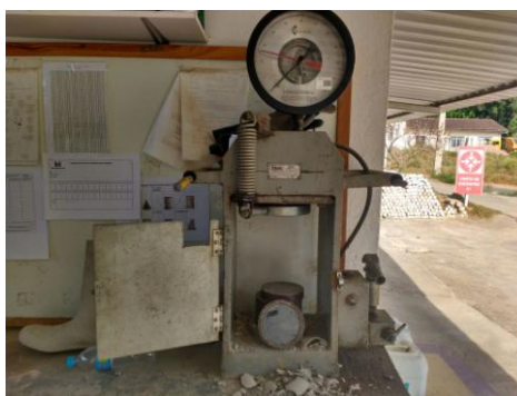
Figura 3 – Prensa hidráulica manual usada para o rompimento dos corpos de prova
