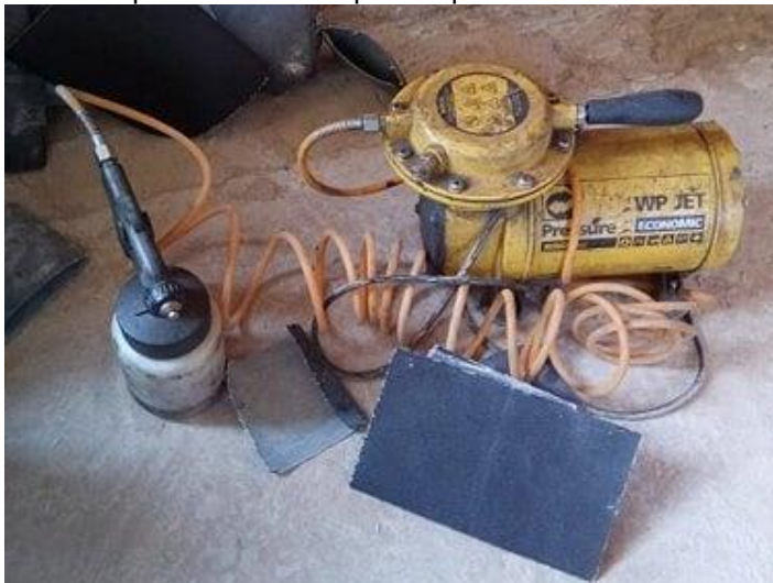
Figura 7 – Compressor utilizado para espalha o óleo diesel nas formas.
